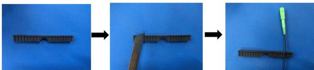
4.3.8 Установите уплотнитель дроп-кабелей в корпус муфты, подключите дроп-кабель в соответствующий адаптер, вложите дроп-кабель в прорезь. Закройте крышку, закройте ее на ключ.
