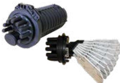
**Оптические муфты FOSC 400 A4** предназначены для установки на воздушных опорах, в кабельной канализации и непосредственно в грунте. Герметизация корпуса с помощью механического замка упрощает монтаж и вскрытие муфты. Поставляются 2 модификации муфты FOSC-400 A4 - на 2 и на 4 сплайс-кассеты.
