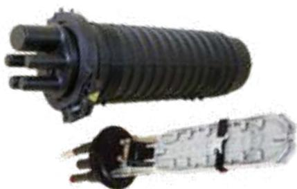
**Оптическая муфта FOSC 400 B2 и FOSC 400 B4** отличаются только конфигурацией кабельных вводов - муфта B2 имеет 2 больших, а муфта B4 - 4 маленьких круглых вводов. В один круглый ввод муфты B2 можно ввести одновременно по 2 кабеля, используя разветвительный зажим BOCL. Количество кабельных портов: 2 или 4 круглых + 1 овальный
