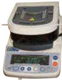
**Влагомер AND MS-70** - для контроля содержания влаги в материалах в процессе производства.
