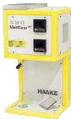
**Прибор измерения показателя текучести расплава SWO Haake** - для подтверждения качества полимеров, применяемых в производстве.
