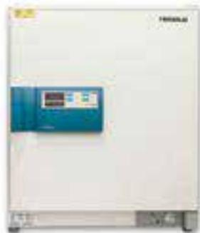
**Термошкаф Heraeus** - для контроля качества полимеров и полуфабрикатов, используемых при производстве оптического кабеля, посредством термических испытаний до + 300°C.
