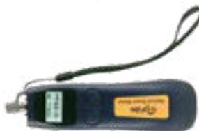
**Измеритель оптической мощности Grandway FHP-A12** - миниатюрный измеритель оптической мощности, предназначенный для работы в сетях телеком. Калибровочные длины волн 850/1300/1310/1490/1550/1625 нм, динамический диапазон 70 ~ +10 дБм (на длине волны 1550нм). Вес 70г.
