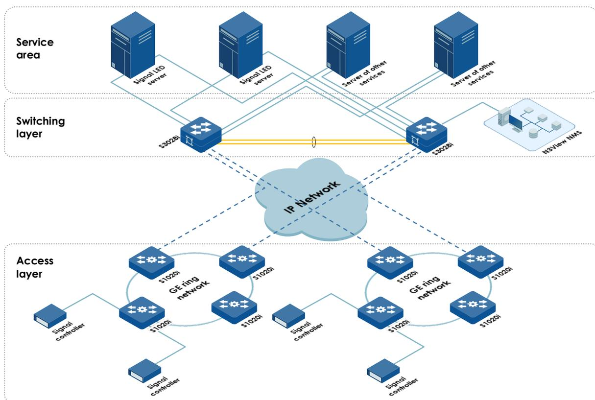
Коммутаторы серии N3-S1020i используются в качестве устройств доступа на сети мониторинга информации для передачи данных с камер, датчиков и других промышленных компонентов, они могут быть подключены в топологии типа кольцо или звезда к устройствам агрегации. В качестве устройств агрегации на следующем уровне сети выступают коммутаторы серии N3-S3028i или другие серии N3Com, такие как N3-721/N3-711, а также устройства других производителей, поддерживающих протокол G.8032.
